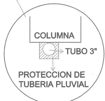
Detalle de protección de tubería
