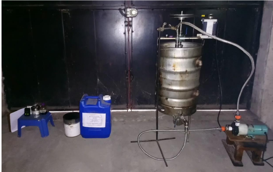
Figura 42. Reactor piloto con crudo Atzam y datos
