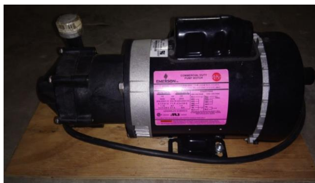
Figura 6. Bomba de 0,5 HP
