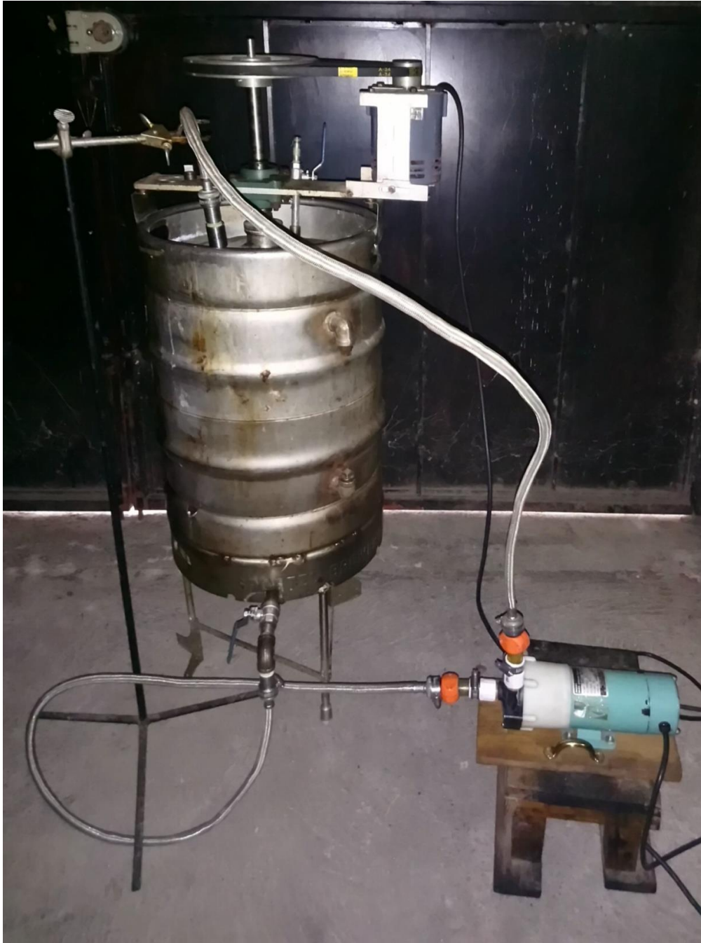
Figura 41. Reactor piloto 12 galones
