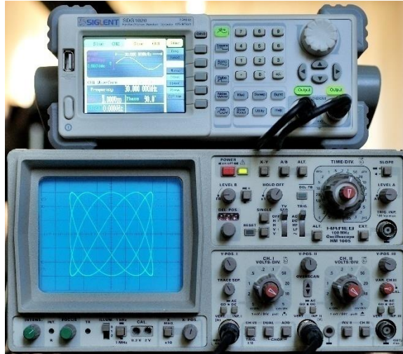
Figura 31. Generador de señales y osciloscopio
