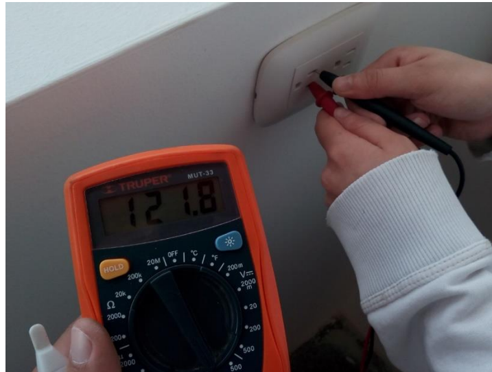
Figura 125. Medición de voltaje en cada tomacorriente
