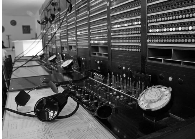
Figura 12. Central telefónica operada manualmente
