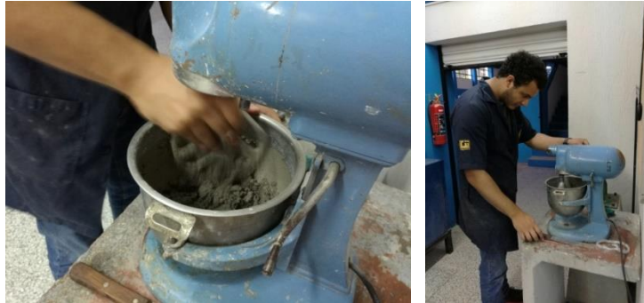
Figura 7. Homogenización y mezclado de los morteros
