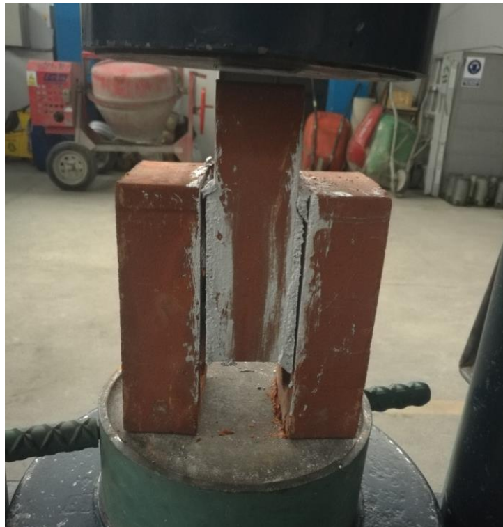
Figura 19. Ensayo de adherencia en ladrillos de barro cocido
