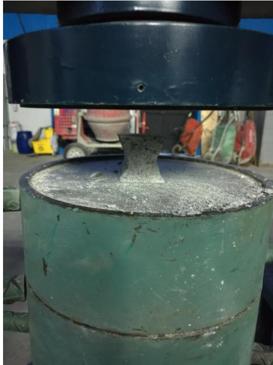
Figura 15. Ensayo de compresión a cubos de mortero de 50 mm
