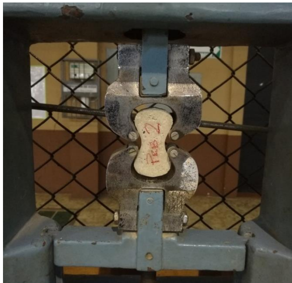
Figura 16. Ensayo a tensión en briquetas de mortero
