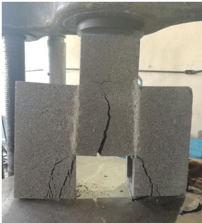
Figura 18. Ensayo de adherencia en bloques de concreto
