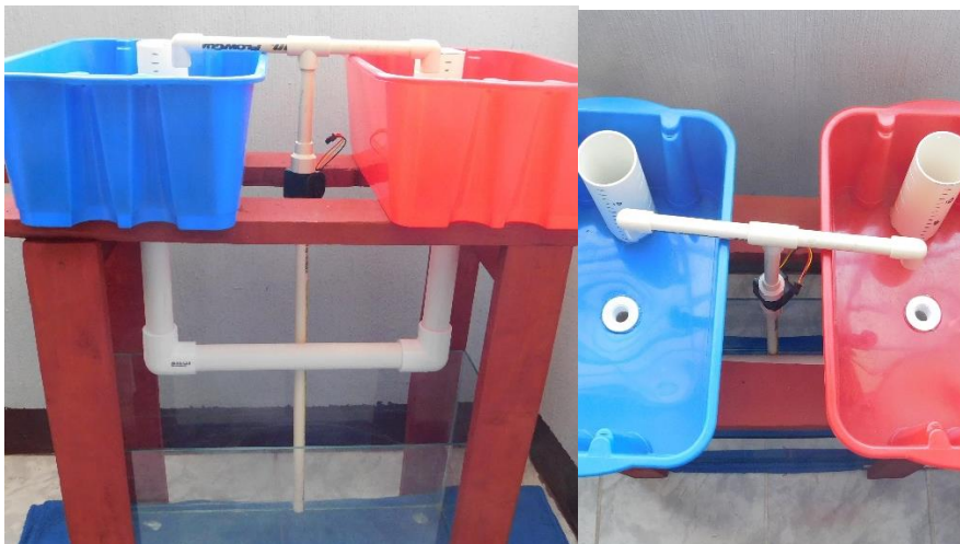
Figura 85. Tubería instalada con sensor de caudal
