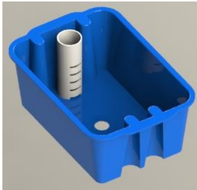
Figura 47. Propuesta de montaje del tubo PVC en la cama de sembrado
