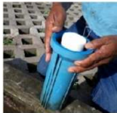
Fig. 5. Colocación del filtro dentro del case.
