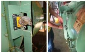
Fig. 10. Jefe de peletizado procede a usar la llave de seguridad.
