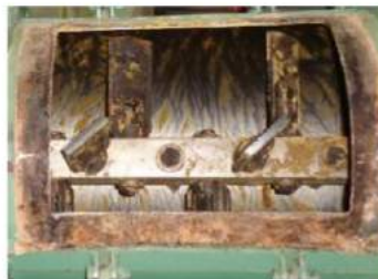
Fig. 4. Jefe de peletizado limpia mediante una espátula las paletas.
