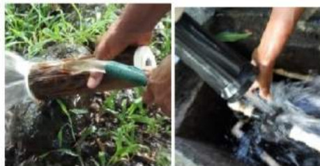
Fig. 4. Lavado de filtro.
