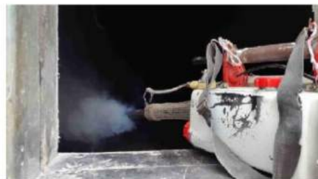
Fig. 10. Jefe de sanitización aplicando humo con thermonebulizadora dentro del silo.
