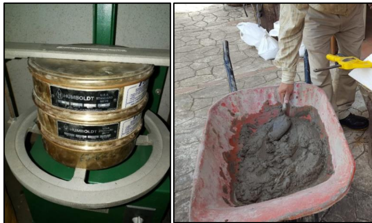
Figura 47. Tamizado y elaboración de mezcla para fundición de prisma triangular
