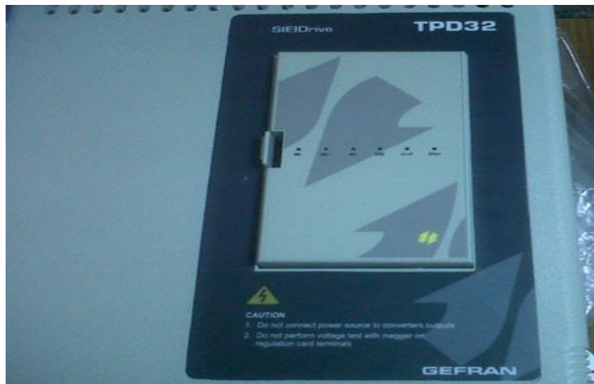
Figura 15. Variador de DC
