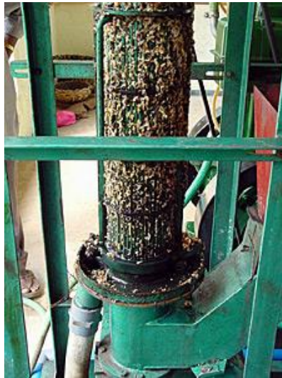
Figura 13. Remoción del mucílago de café, mecánicamente
