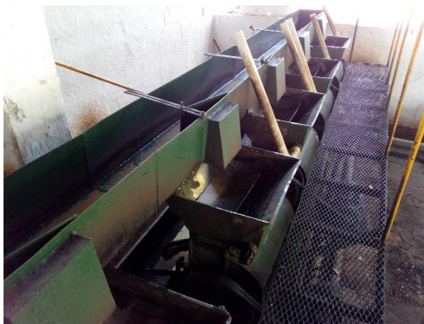
Figura 9. Pulperos, despulpado del café
