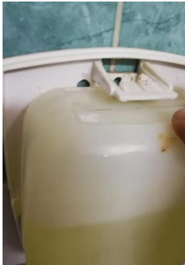
Figura 47. Bisagra quebrada de desodorizador
