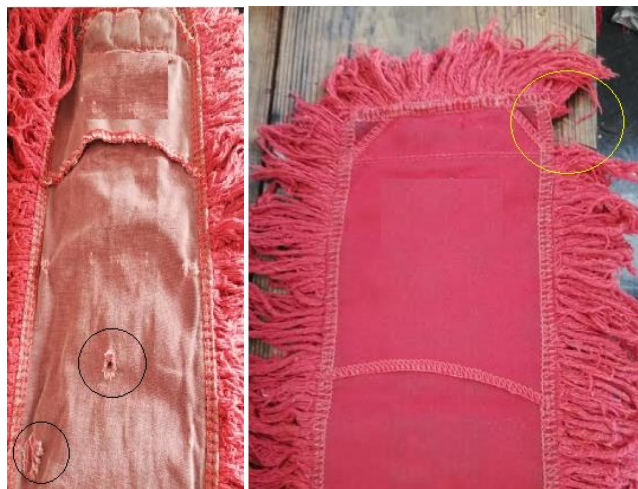
Figura 30. Desgaste de y daños en mopas
