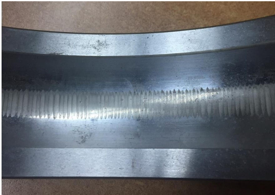
Figura 17. Falla causada por paso de corrientes parásitas
