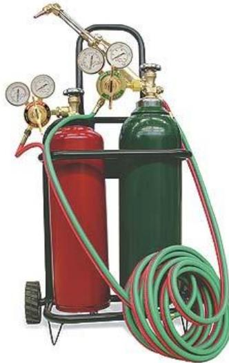
Fuente: Conexión Canacintra. *Equipo móvil para cortar y soldar.*
