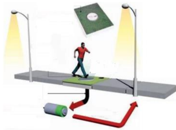
Figura 22. Sistema de recolección de energía por medio de la pisada del ser humano
