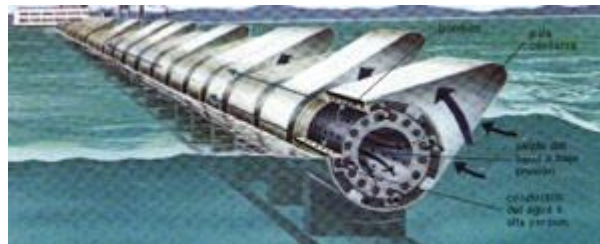
Figura 6. Presa de marea
