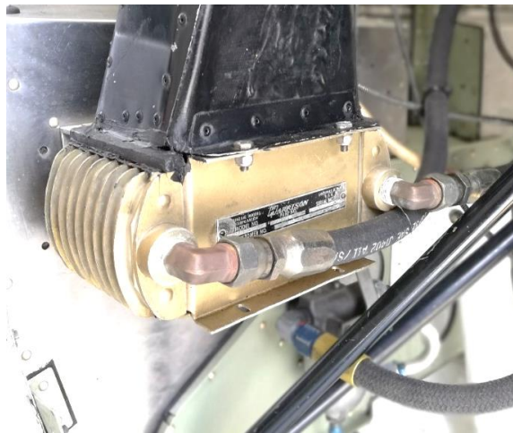
Figura 20. Enfriador de aceite
