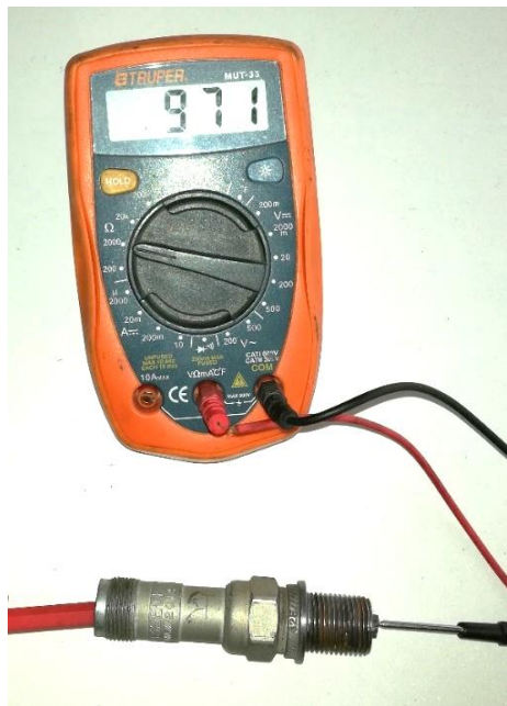
Figura 16. Medición de ohmios de bujías
