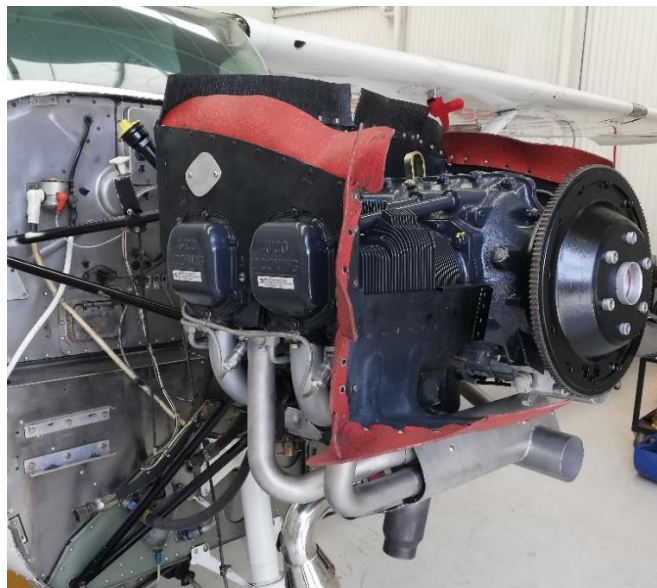
Figura 7. Motor alternativo de la aeronave Cessna 172
