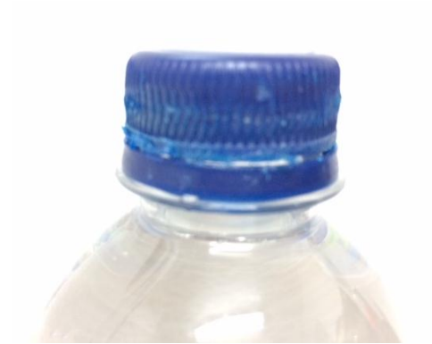
Figura 12. Tapa dañada de un envase PET
