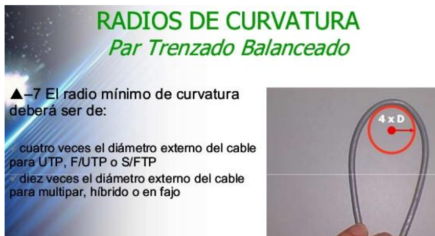
Figura 144. Radio mínimo de curvatura para cable UTP
