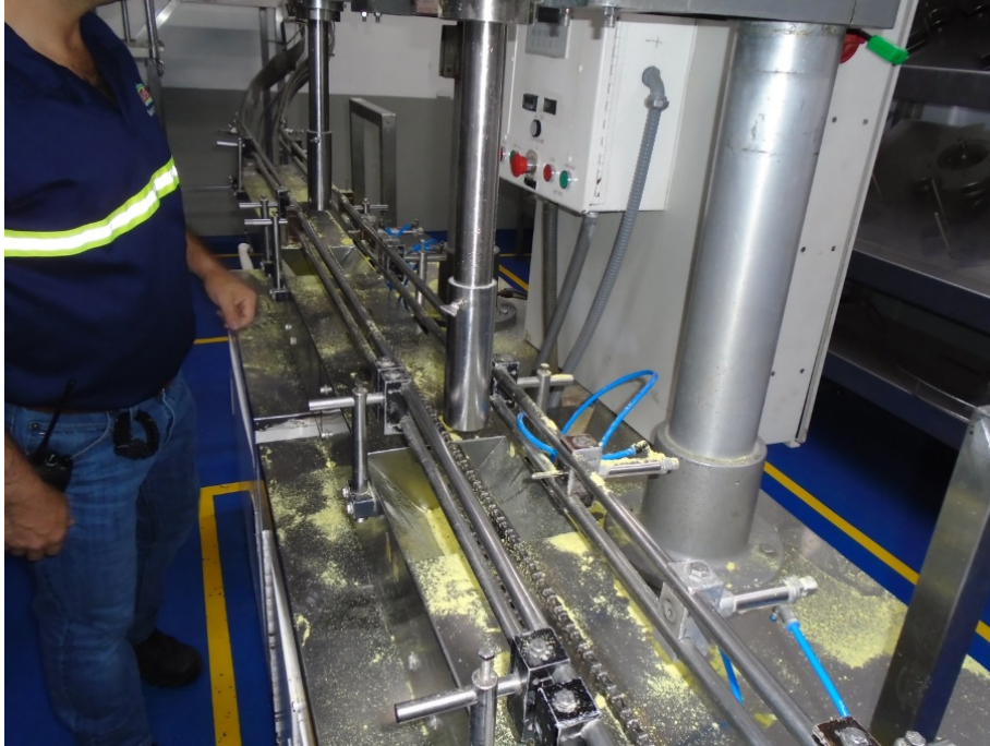
Figura 41. Suciedad encontrada en la limpieza inicial
