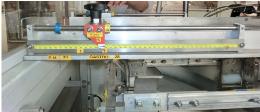
Figura 55. Punto estático de centerlining en carrilera
