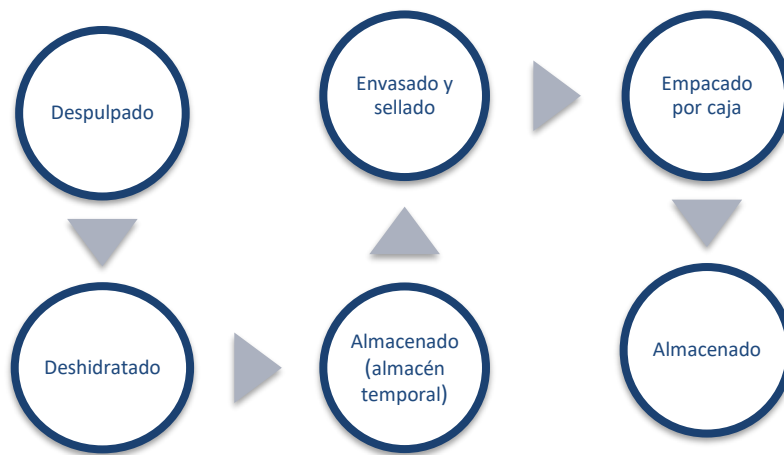
Figura 19. Flujo del proceso de producción de té a raíz del reprocesamiento de la pulpa residual del fruto de café.
