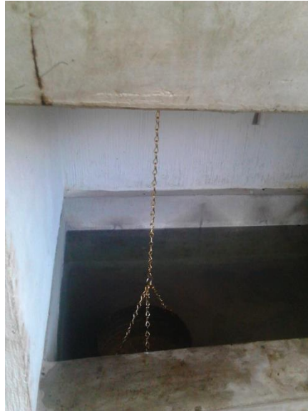
Figura 14. Pileta de agua para suspensión de probeta
