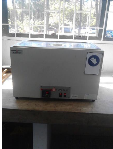
Figura 17. Recipiente con control termostático
