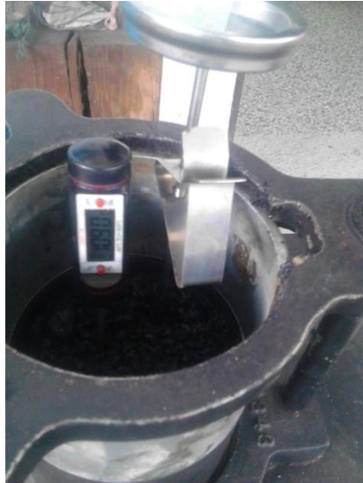
Figura 11. Pedestal de compactación y termómetro para medición de temperatura
