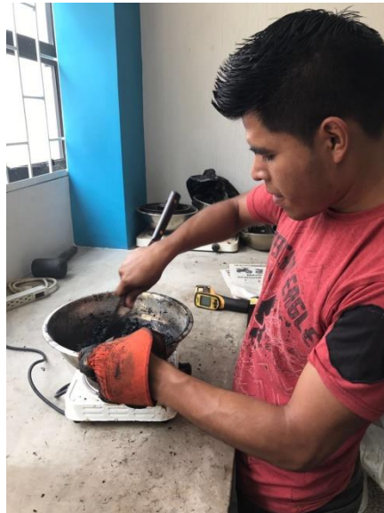
Figura 10. Equipo utilizado para calentar mezcla asfáltica
