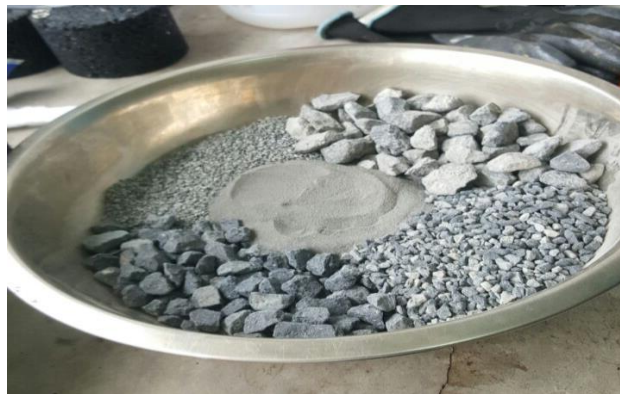
Figura 7. Tara con muestra de agregados gruesos y finos
