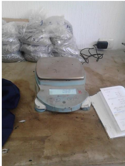
Figura 12. Equipo de medición de material para mezcla asfáltica
