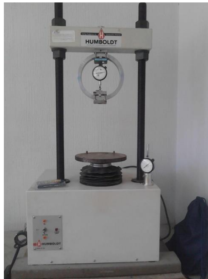
Figura 16. Anillo dinamométrico y deformímetro de lectura fija
