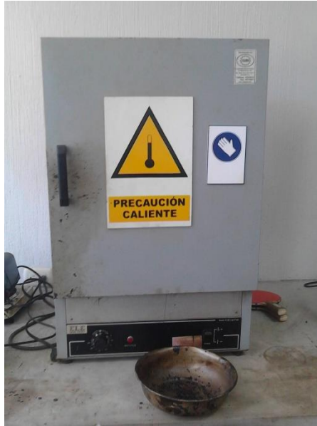
Figura 9. Equipo utilizado para calentar agregados
