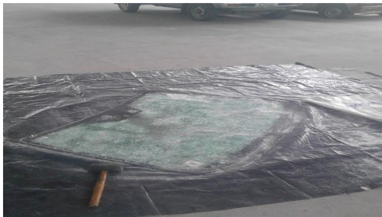
Figura 5. Trituración de planchas de vidrio templado
