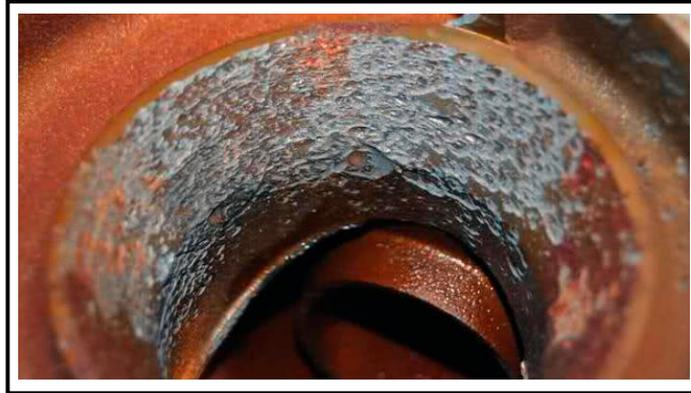
Fuente: *Cavitación en las bombas hidráulicas*. [www.hidrooil.es/articulo/cavitacion-en-las-bombas-hidraulicas](http://www.hidrooil.es/articulo/cavitacion-en-las-bombas-hidraulicas). Consulta: 29 de diciembre de 2018.
