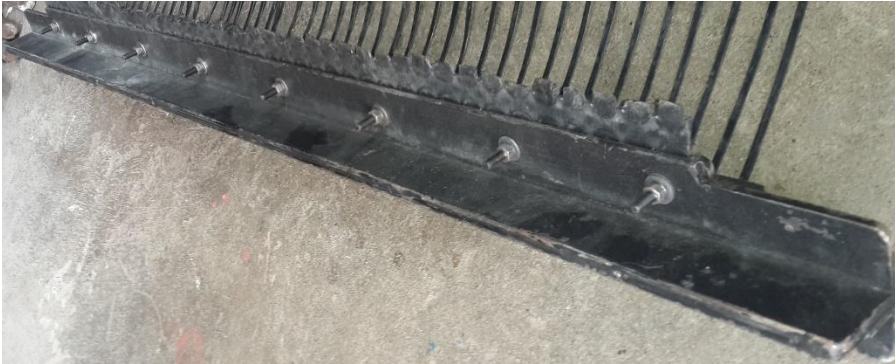
Figura 14. Perfil para aplicar carga uniforme al refuerzo
