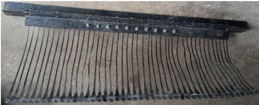
Figura 15. Geomalla ensamblada en perfil
