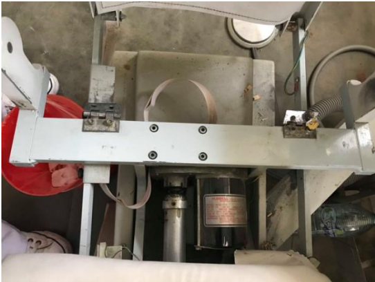
Figuras 24, 25, 26 y 27 Se atornilló y se aseguró el sillón a la unidad dental.
