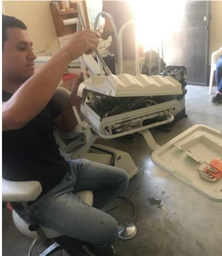
Figuras 22 y 23. Reparación y mantenimiento de la caja de piezas de mano y unidad dental.
