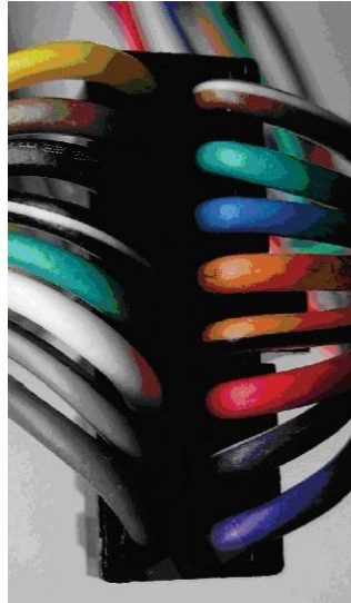
Figura 45. Colores de cables en GV300
