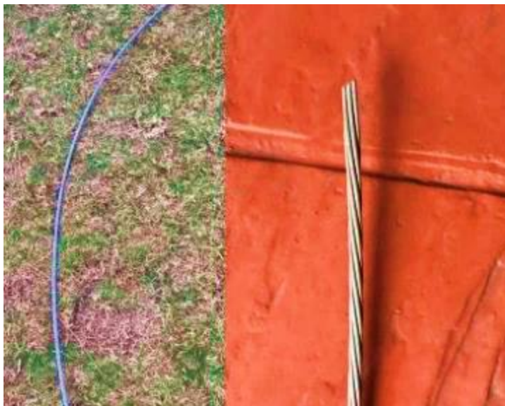
Figura 30. Cable de acero galvanizado 5/16
