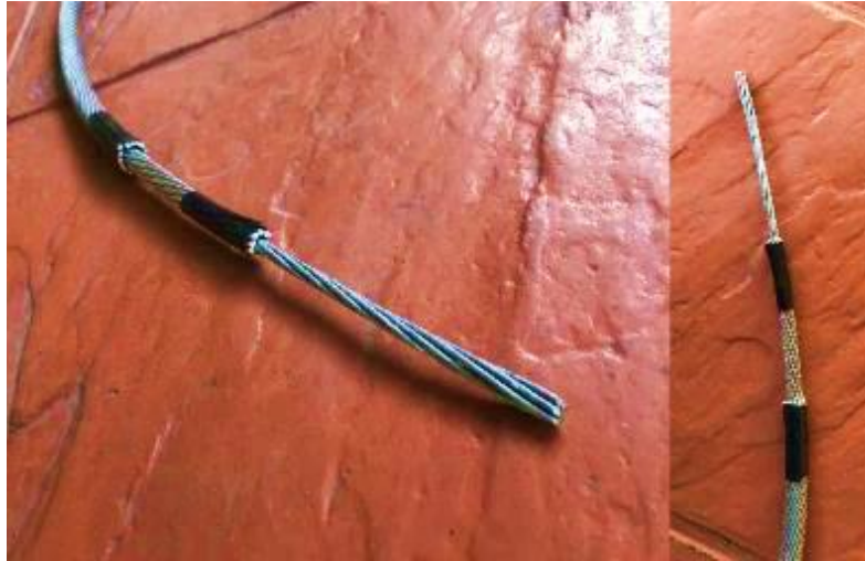
Figura 27. Cable de aluminio sin forro 266.8 AWG ACSR ( partridge )
