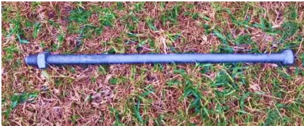
Figura 39. Tornillo de máquina de 19,05 mm (3/4"x20")
