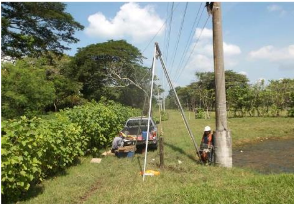
Figura 16. Prueba de penetración estándar (SPT)
