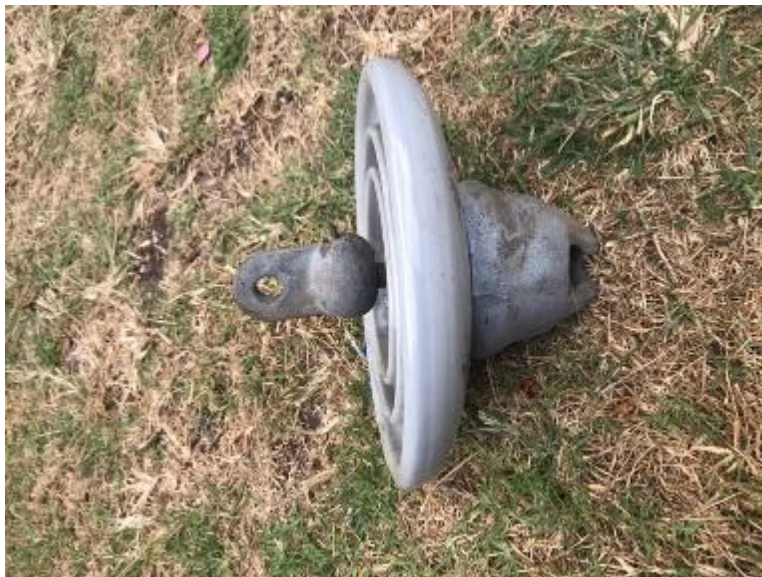
Figura 37. Aislador de porcelana de remate de disco de 10" para monopolos de líneas de transmisión de 69 kV
