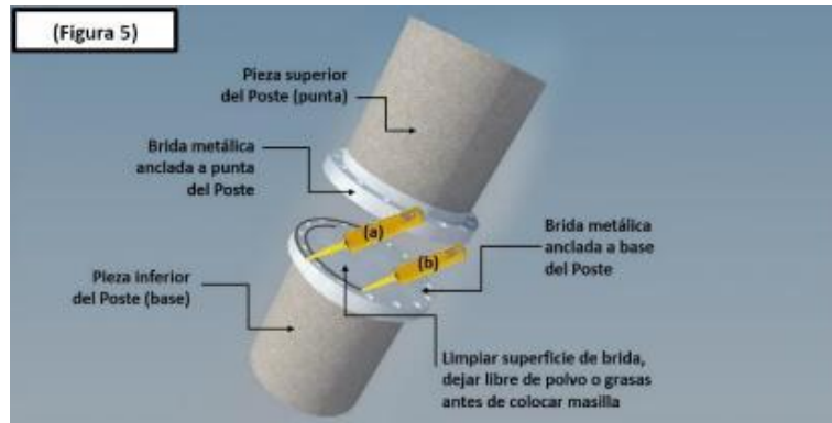
Figura 128. Aplicación de masilla epóxica en flange
