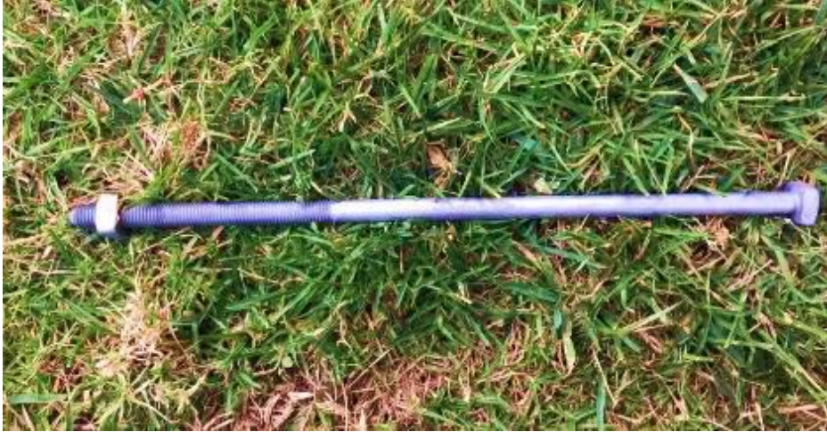
Figura 55. Tornillo de máquina de 15,87 mm (5/8"X18")
