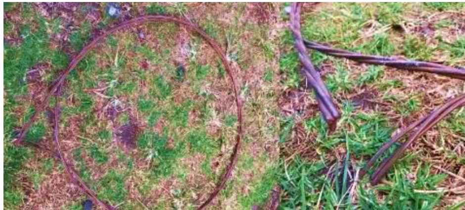
Figura 89. Cable copperweld núm. 2
