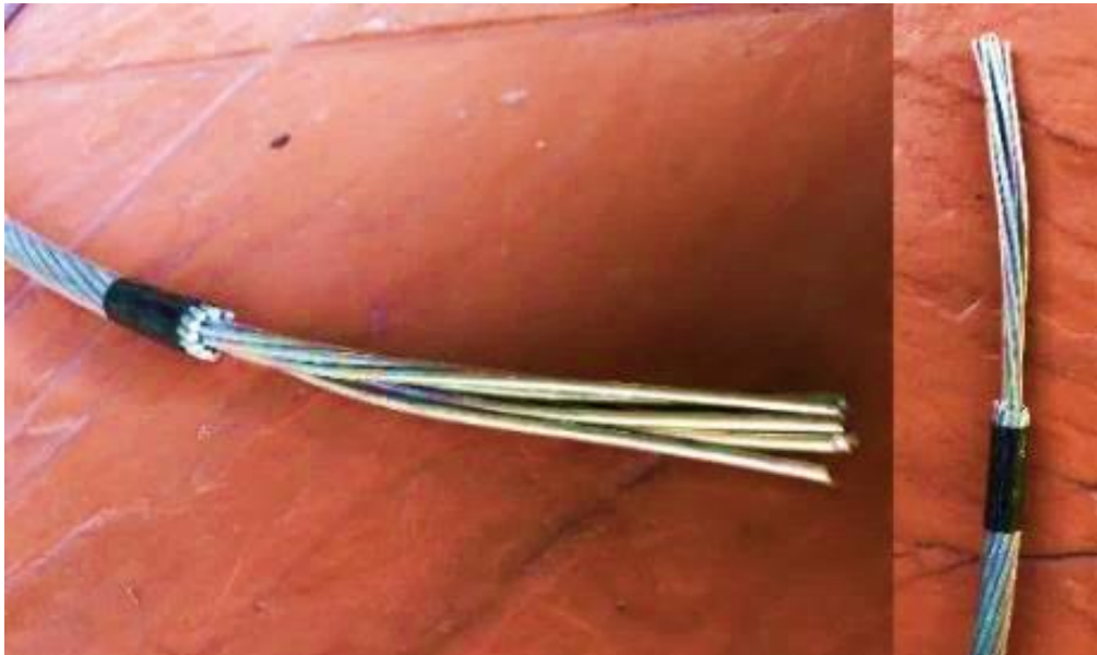
Figura 26. Cable de aluminio sin forro 394,5 AWG AAAC (cantón)
