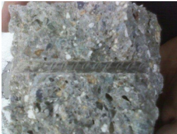
Figura 19. Graut-huella de refuerzo
