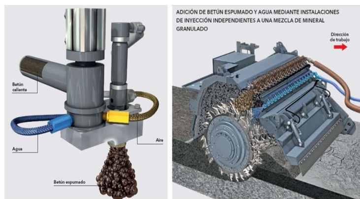
Figura 5. Proceso de asfalto espumado con recicladora
