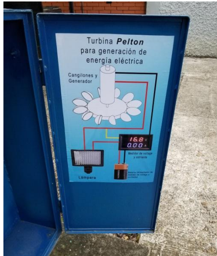
Figura 34. Conexión de componentes turbina Pelton
