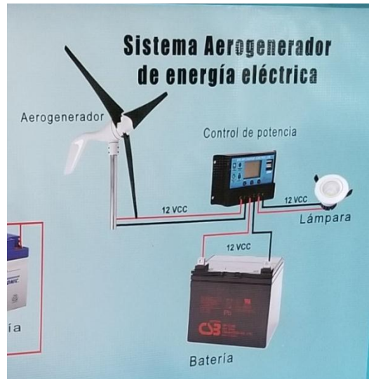
Figura 46. Conexión de componentes de aerogenerador
