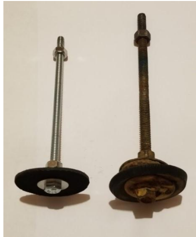
Figura 51. Antes y después de la válvula de retención
