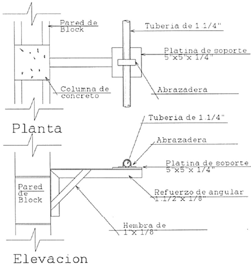
Detalle de anclaje en columna de concreto
