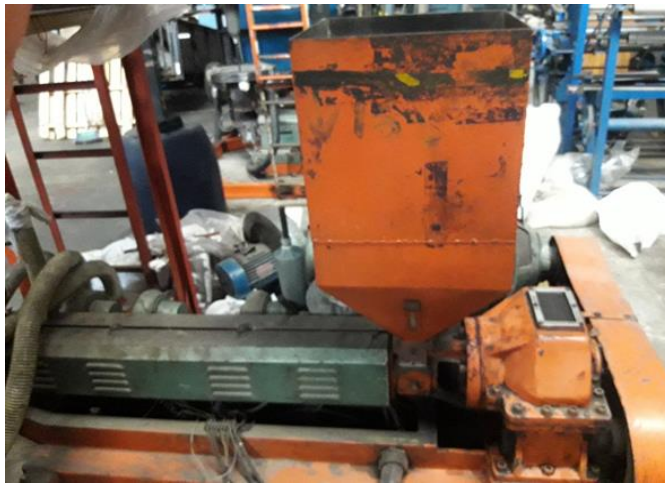
Figura 4. Vista externa de la caja reductora de extrusora Plastimac
