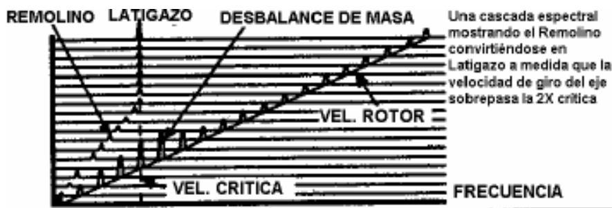
Figura 55. Espectro típico de inestabilidad por latigazo de aceite
