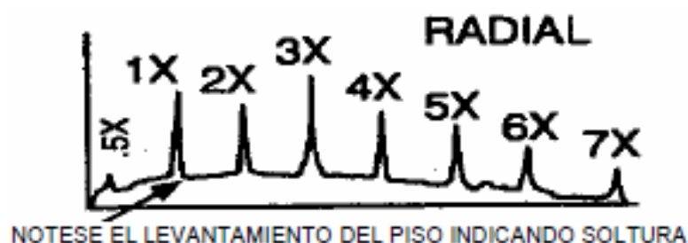
Figura 53. Espectro típico de problemas por desgaste
