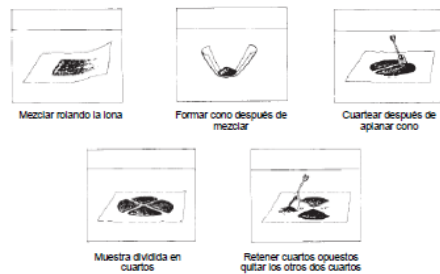
Fig. 4 – Cuarteo sobre una lona de cuarteo
