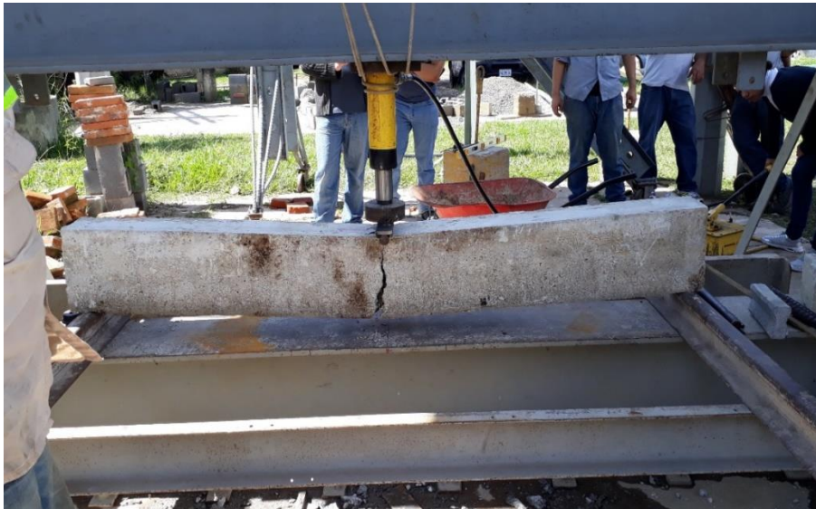
Figura 38. Ensayo a flexión para elemento viga, utilizando azúcar como aditivo retardante en el hormigón
