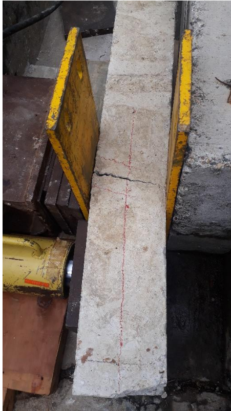
Figura 28. Ensayo de corte a elemento viga sin aplicación de aditivo
