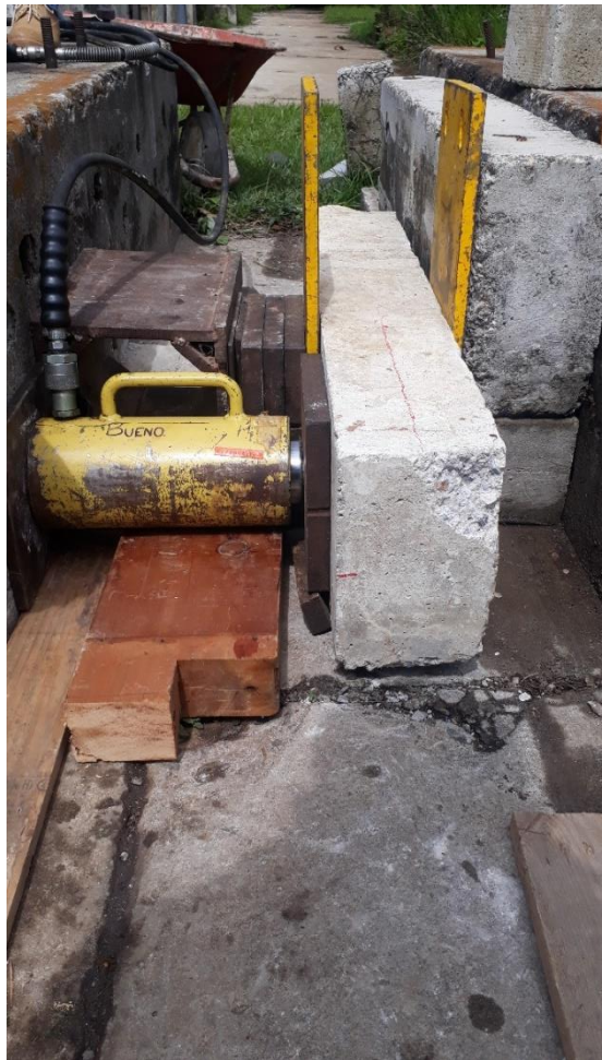
Figura 27. Colocación de elemento viga para ensayo a corte
