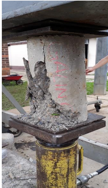
Figura 14. Ensayo a compresión de cilindros de concreto sin ningún tipo de aditivo
