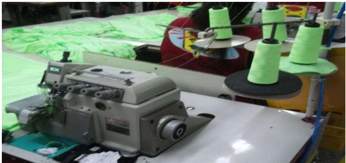
Apéndice 7. Máquina overlock para cerrar costados
