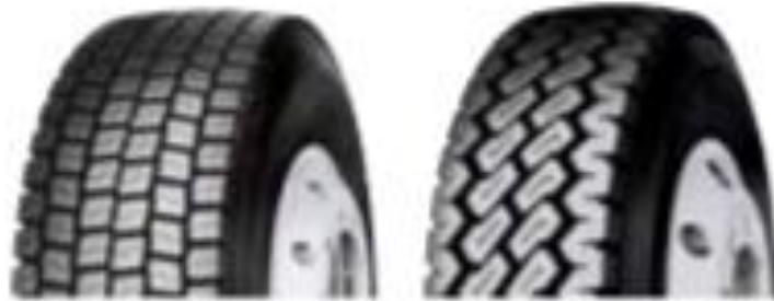
Figura 13. Aplicación de neumáticos a ejes de tracción
