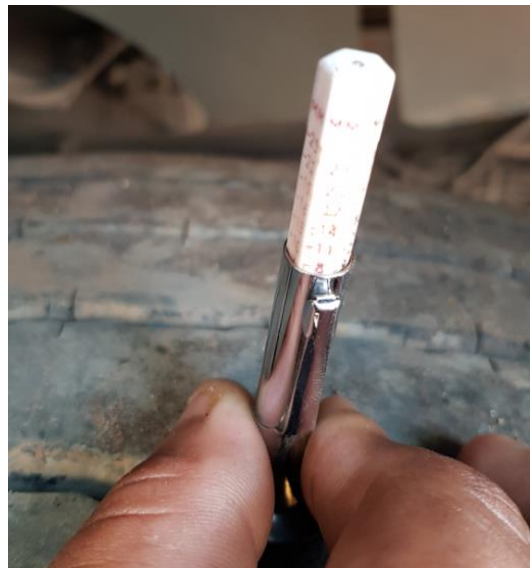
Figura 32. Toma de profundidad
