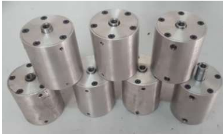
Figura 37. Actuadores nuevos para sustituir dañados y realizar correcciones
