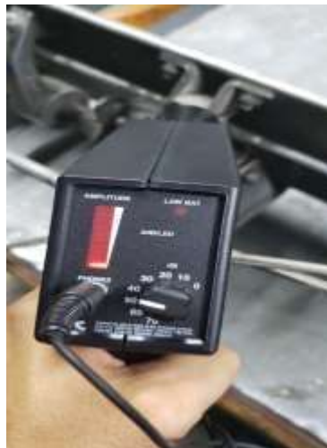
Figura 28. Medición mediante la técnica de ultrasonido
