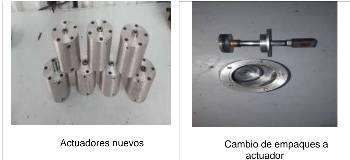
Figura 41. Mantenimiento correctivo a actuadores
