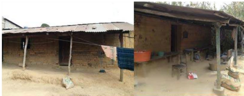
Figura 6. Vivienda con medios muros y finalizado con varillas de caña de castilla
