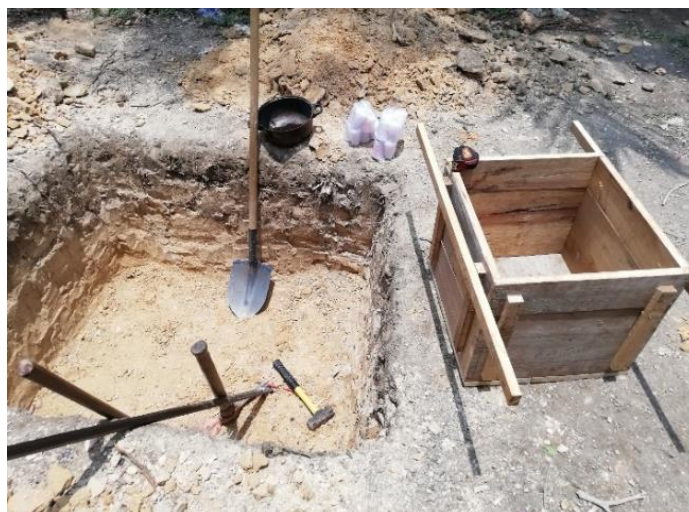
Figura 3. Toma de muestra de suelo 1 pie cúbico
