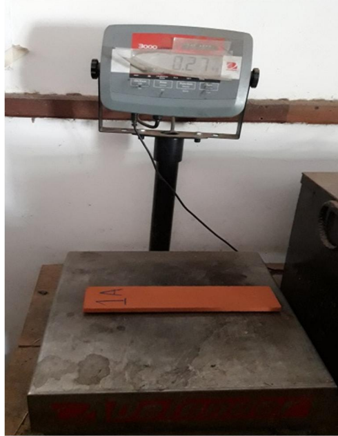
Figura 71. Peso de elementos cerámicos secos
