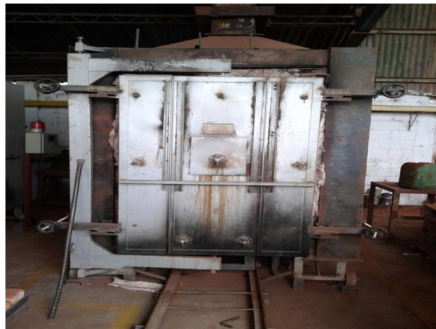
Figura 10. Horno de secado para fachaletas
