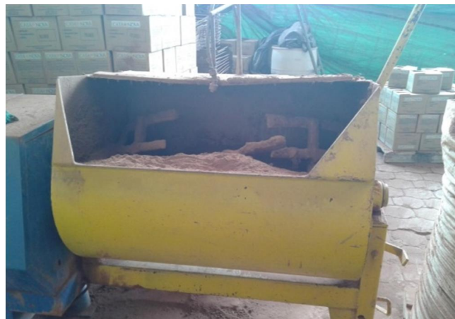
Figura 6. Tolva de humectación para arcilla roja
