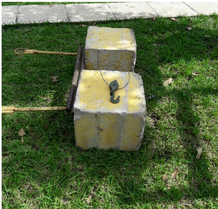
Figura 23. Contrapesos de concreto
