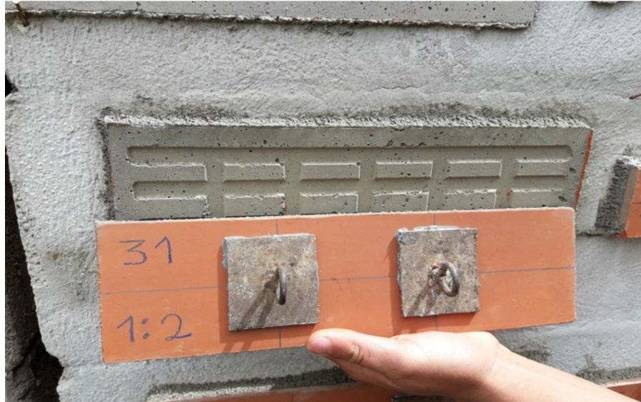
Figura 68. Falla adhesiva entre la interfaz del adhesivo y la fachaleta, mortero 3 (falla B)
