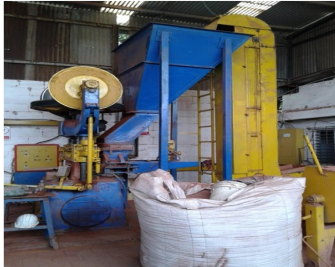
Figura 7. Máquina para moldear arcilla molida
