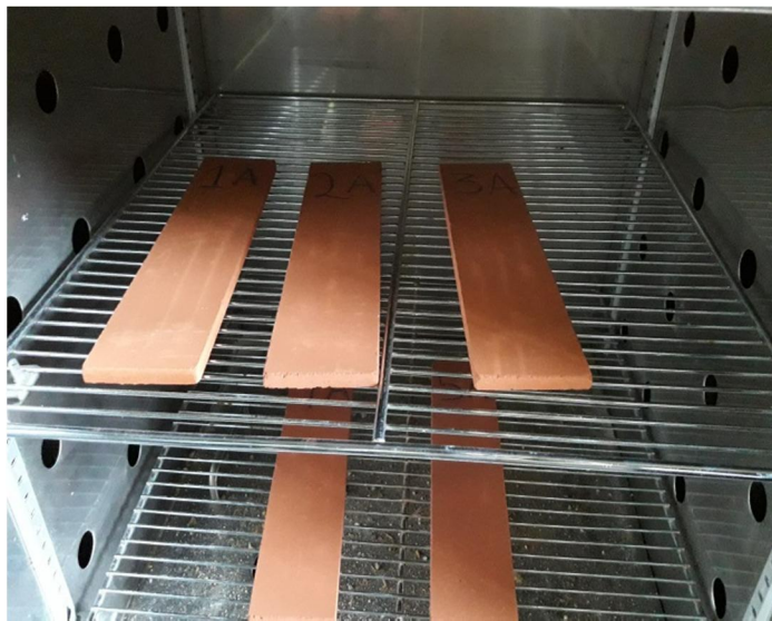
Figura 70. Secado de elementos cerámicos
