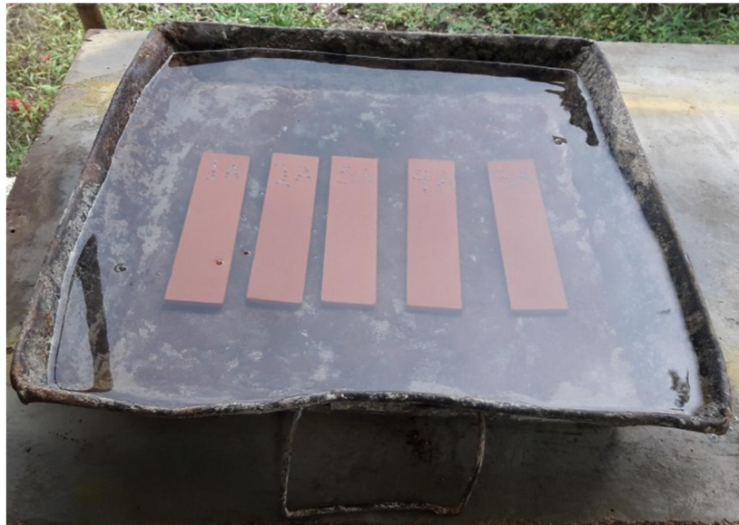
Figura 72. Elementos cerámicos en proceso de absorción de agua
