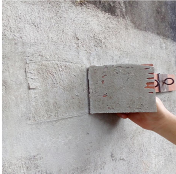
Figura 62. Falla adhesiva en la interfaz entre el adhesivo y el soporte, mortero 1 (falla A)
