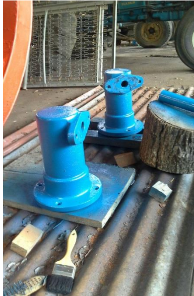
Figura 92. Cilindros hidráulicos restaurados
