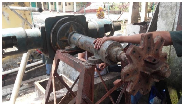
Figura 64. Desmontaje de rueda de cangilones hidráulicos
