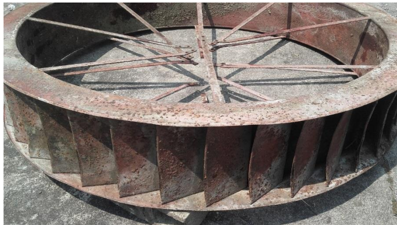
Figura 65. Fotografía de rueda de cangilones hidráulicos desmontada
