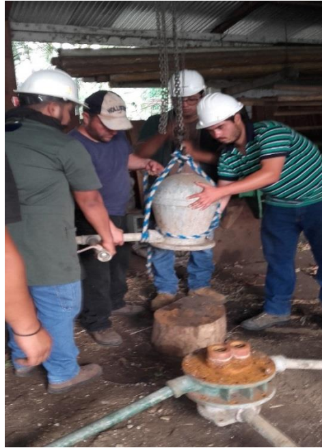
Figura 71. Fotografía del desmontaje de cámara estabilizadora
