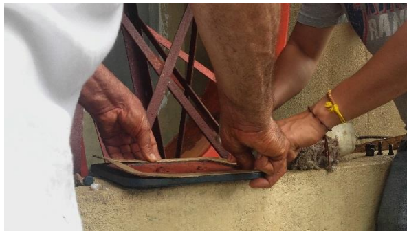
Figura 102. Sellado del cárter de lubricación con fibra de caucho
