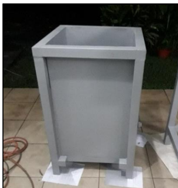
Figura 20. Aplicación de pintura a tanque de almacenamiento
