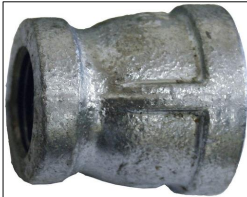
Figura 74. Reductor concéntrico tipo campana de acero galvanizado de \frac{3}{4} a \frac{1}{4} pulgada rosca hembra NPT
