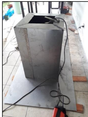
Figura 4. Proceso de construcción de tanque de agua
