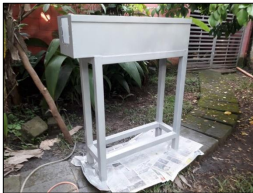
Figura 18. Aplicación de pintura a canal y soporte
