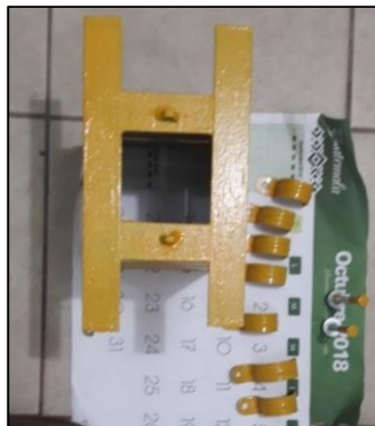
Figura 21. Aplicación de pintura a soporte empaque para disipación de energía
