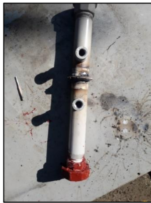
Figura 11. Soldadura de coplas para manómetros de medidor de placa de orificio
