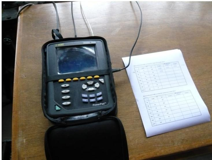
Fotografía 2. Medidor de calidad de energía eléctrica con el cual se registraron los valores de energía producida durante las pruebas. Laboratorio de Operaciones Unitarias, Facultad de Ingeniería, USAC. Tomada por Carlos Echeverría el 4 de octubre del 2008.
