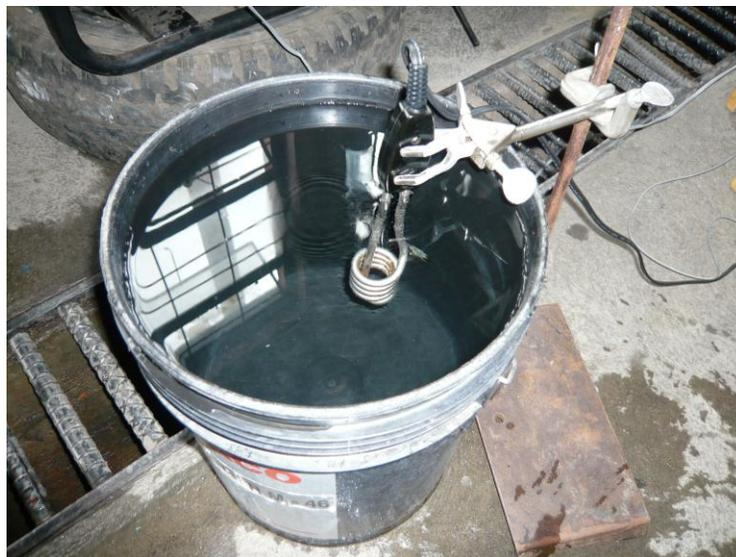
Fotografía 4. Resistencia eléctrica de 1 kW. Laboratorio de Operaciones Unitarias, Facultad de Ingeniería, USAC. Tomada por Carlos Echeverría el 4 de octubre del 2008.
