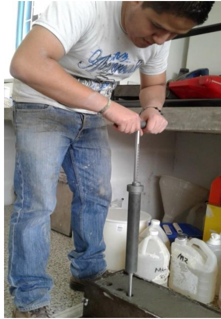
Penetración de viga
