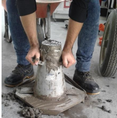
Vaciado de mezcla del cono
