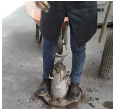
Llenado de cono con mezcla
