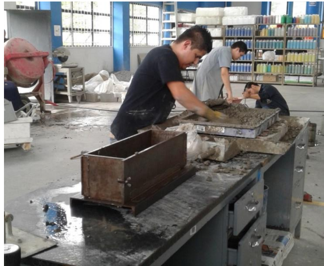
Llenado de cilindros y tamizado de concreto fresco
