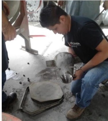
Elaboración de prueba de asentamiento
