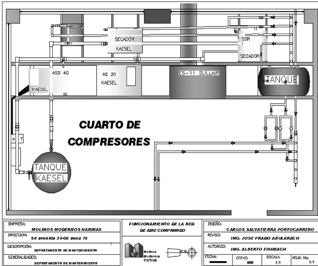
Figura 119. Diseño mejorado del cuarto de compresores
