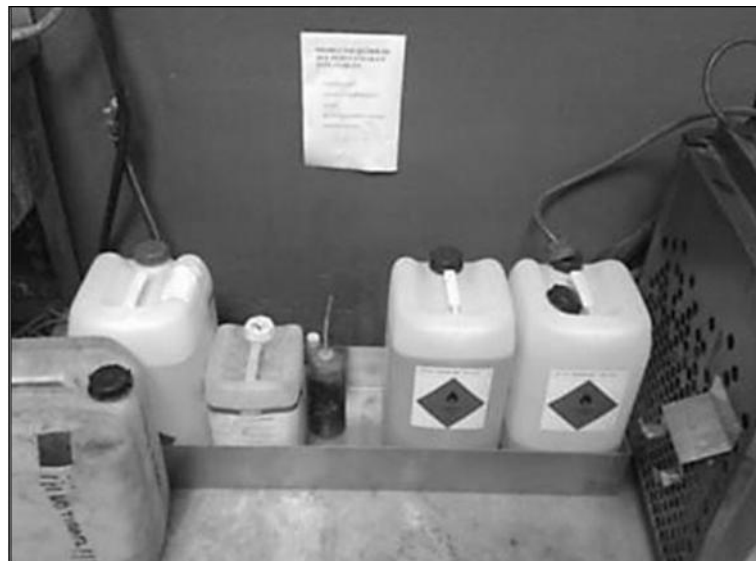
Figura 32. Solventes almacenados de forma incorrecta
