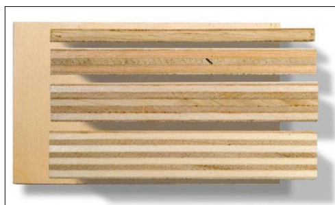
Figura 11. Estructura de un tablero contrachapado
