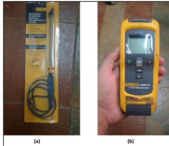
Figura 19. Medidores de temperatura de superficie (a) Termocupla 80PK-27 (b) Módulo inalámbrico de temperatura tipo K
