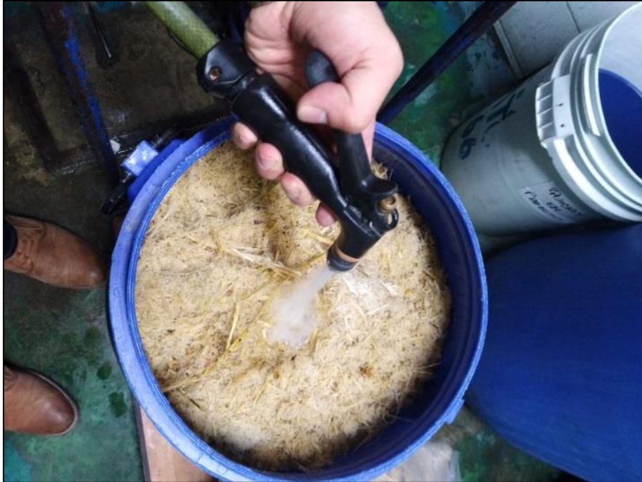
Figura 8. Lavado de azúcares con agua suavizada
