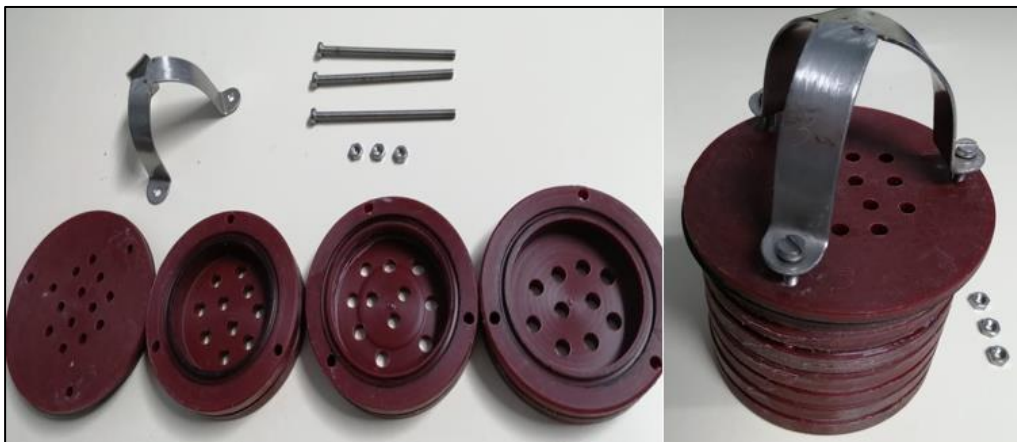
Figura 19. Sistema sustituible de plato y marco
