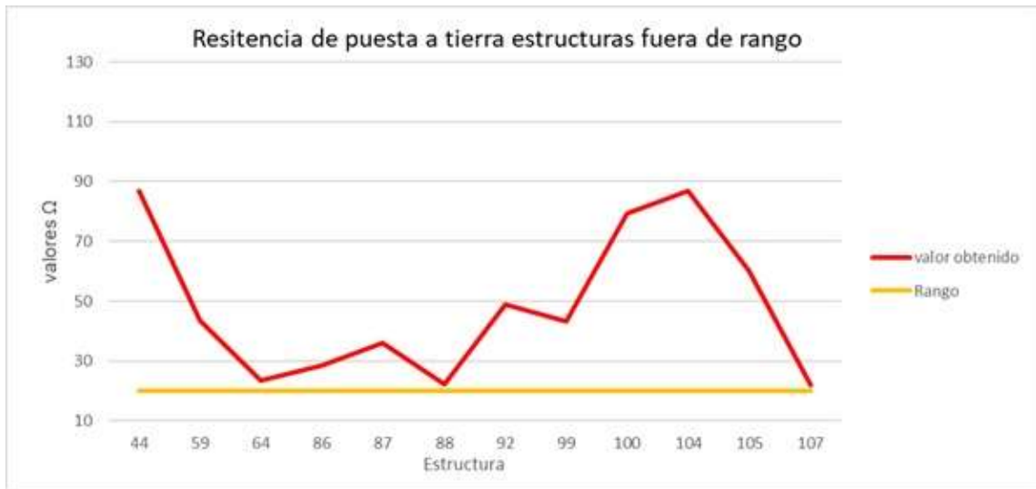
Figura 53. Gráfica de datos con valores fuera de rango de resistencia de puesta a tierra
