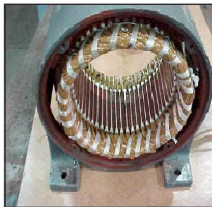
Bobinado excéntrico/imbricado típico.
