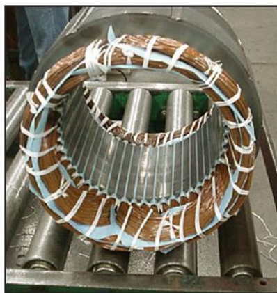
Bobinado concéntrico típico.
