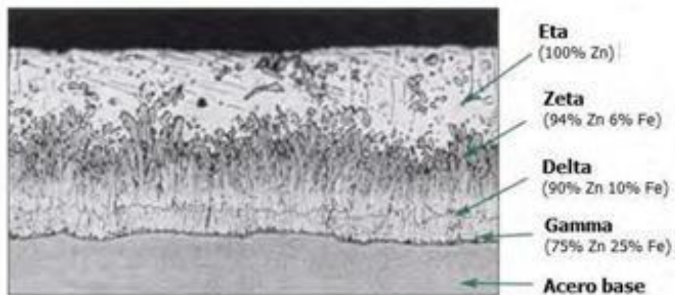
Figura 3. Micrografía de las capas intermetálicas de un convencional acero galvanizado obtenido por inmersión en caliente
